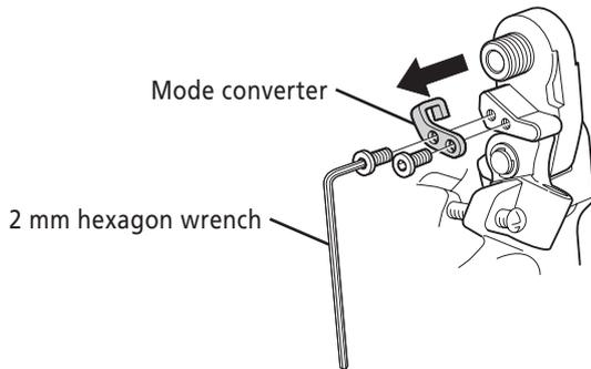
**Tightening torque: 1 - 1.5 N·m**
